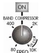
El control de compresor de banda, permite configurar la banda seleccionada desde 80 Hz a 10 KHz. Configurado el control de compresor de banda, entre 5 KHz y 10 KHz actúa como DE-ESSER, es decir, permite reducir notablemente el efecto de seseo que se produce con el tratamiento de señales vocales de gran contenido en altas frecuencias, sobre todo con la letra "s".
