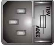
CONECTOR, PORTAFUSIBLES Y SELECTOR DE TENSION DE RED.
