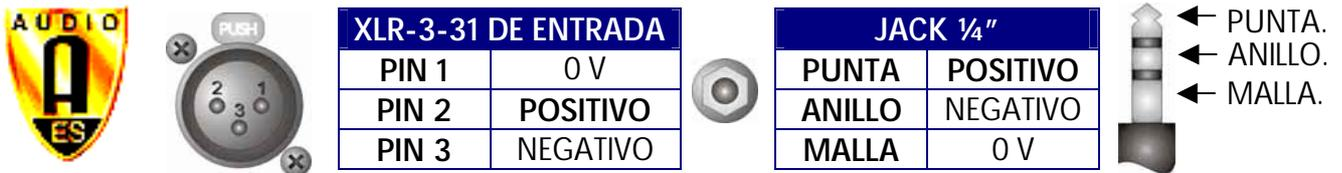
Las conexiones de entrada dependen de dos factores, el primero es la señal de entrada balanceada ó desbalanceada, y el segundo la fuente de sonido flotante ó con conexión a tierra. Los siguientes gráficos muestran algunas de las distintas posibilidades de conexión dependiendo del tipo de señal de entrada, balanceada ó desbalanceada y según la configuración de tierra del equipo (flotante ó a tierra).
