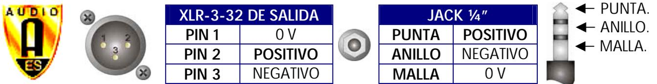
Las conexiones de salida dependen de dos factores, el primero es la señal de salida balanceada ó desbalanceada, y el segundo el destinatario del sonido flotante ó con conexión a tierra. Los siguientes gráficos muestran algunas de las distintas posibilidades de conexión dependiendo del tipo de señal de entrada, balanceada ó desbalanceada y según la configuración de tierra del equipo (flotante ó a tierra).
