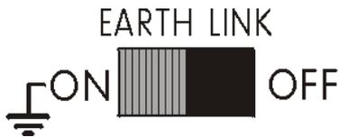
TIERRA DE RED UNIDA A LA MASA ELÉCTRICA DEL DISTRIBUIDOR/MEZCLADOR/SPLITTER.
